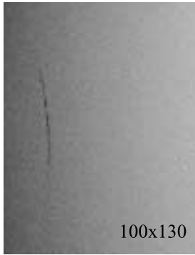
図 3 黒色エラー（黒線キズ）の例 Fig. 3 Example of black error (scratch).
