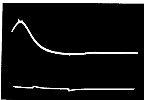
図-11 失火時の圧力波形(空気あり)
