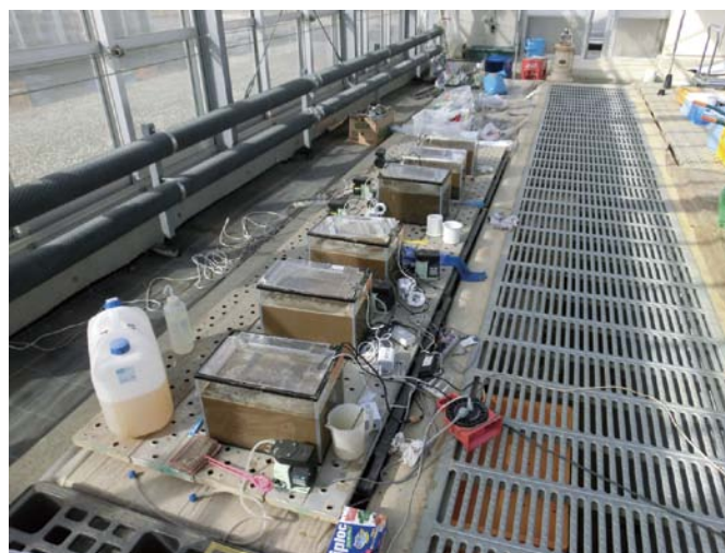
写真1 福島県農業センターでの放射能汚染土壌の光合成細菌ビーズによる除染
