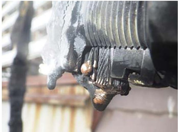
図5 側撃雷による溶融痕
