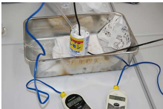
図7 半密閉状態での乾燥剤の発熱実験
