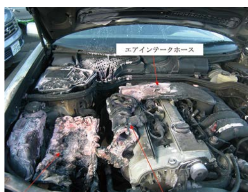
図12 出火車両のエンジンルーム
