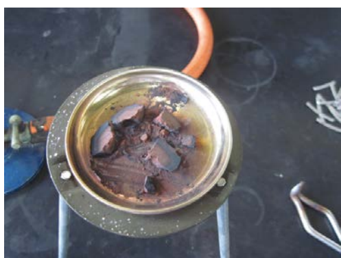
図10 加熱による銅の酸化とその内部
