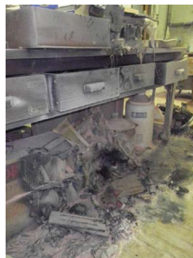
図9 理科準備室での実験金属を含む残渣物からの出火
