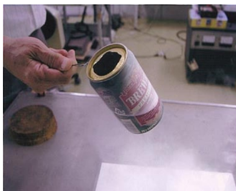
図2. アルミ缶に液体窒素を入れた状態。表面の底辺部に液体酸素が凝結している。
