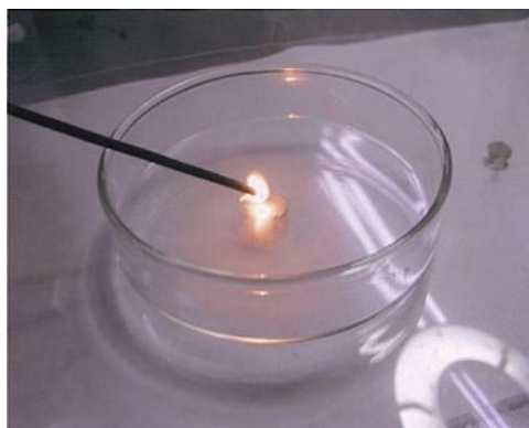
図3. 線香の火を近づけると液体酸素により線香が激しく燃えている。
