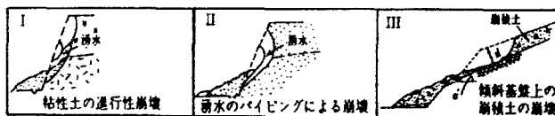
Fig. 2.1 表層崩壊の型
