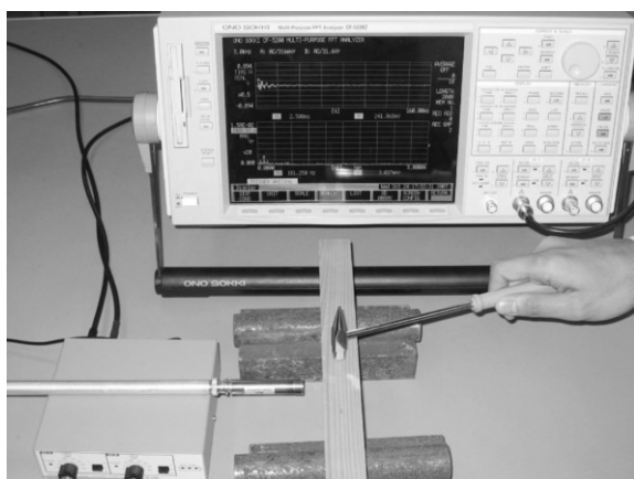
写真4 横振動によるヤング係数測定の状態
