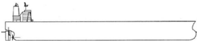
図2 KVLCC2の側面図 ( L_{pp}=320m )
