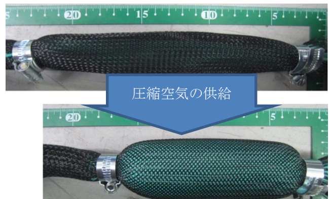
図 5 空気圧人工筋肉の膨張
